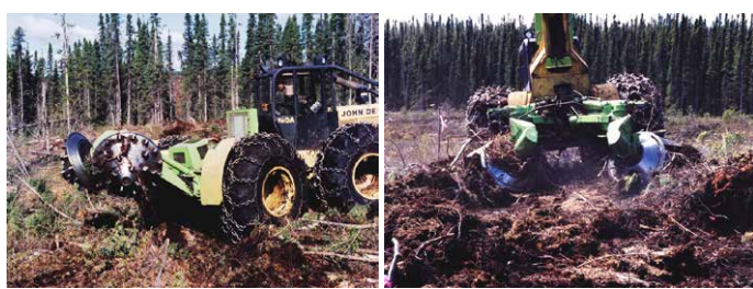
Photo 1. L'étude a été réalisée sur le parterre de coupe d'une pessière à mousses de la forêt boréale. À gauche, le scarificateur à cônes Silva-Wadell. À droite, le scarificateur à disques TTS. En arrière-plan, les lisières boisées qui ont servi de sources d'ensemencement naturel (photos : M. Prévost, MFFP).
