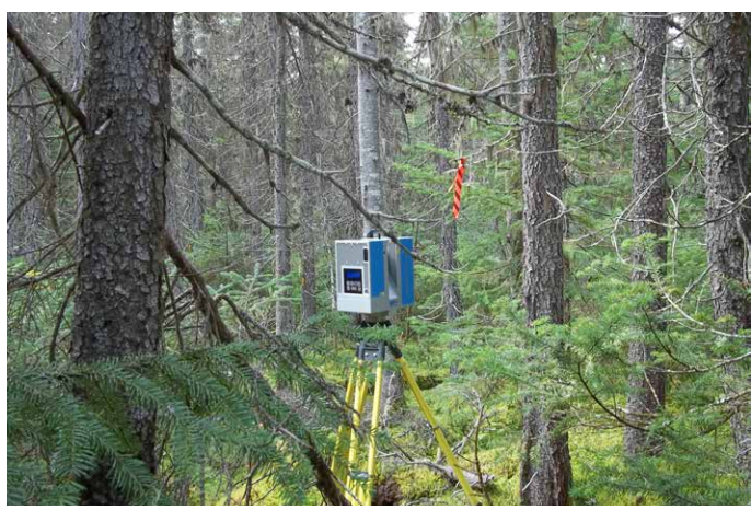
Figure 1. LiDAR-t (Zoller & Fröhlich Imager® 5006i) monté sur un trépied (photo : Guillaume Giroud, MFFP)
