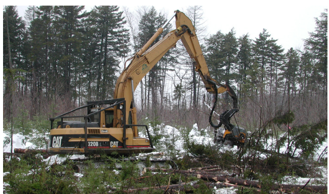
Une abatteuse tronçonneuse a été utilisée lors de la coupe finale en janvier 2006, sur un sol gelé et recouvert de neige. Les débris de coupe étaient placés dans les sentiers (Photo : M. Gagnon).
