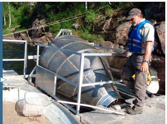
Carol Harvey, technicien de la faune à la DEX-02, vérifie les réglages de la trappe rotative.
