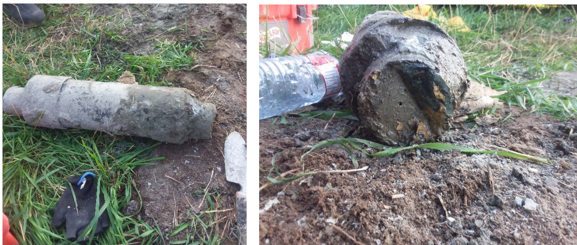
Figure 7: Section du tubage trouvée près du puits A097. Source : MERN.
