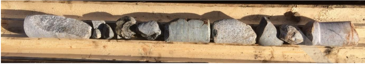
PHOTO 1 FG-18-01B (0,00 à 5,48 m) (dépôts meubles)
