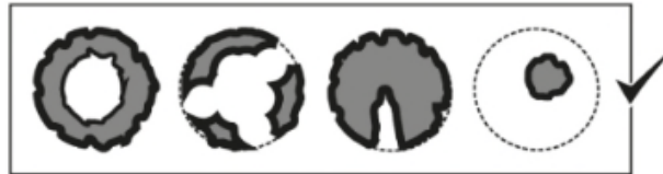
Figure 2 DHP détérioré/altéré : arbre rejeté
