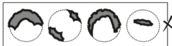
Figure 2 DHP détérioré/altéré : arbre rejeté
