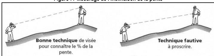
Figure 77 Mesurage de l'inclinaison de la pente
