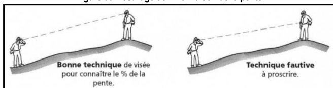
Figure 50 Mesurage de l'inclinaison de la pente
