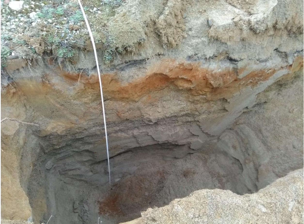
Photo 2: Puits d'exploration PU-01-21 – parois et fond d'excavation
