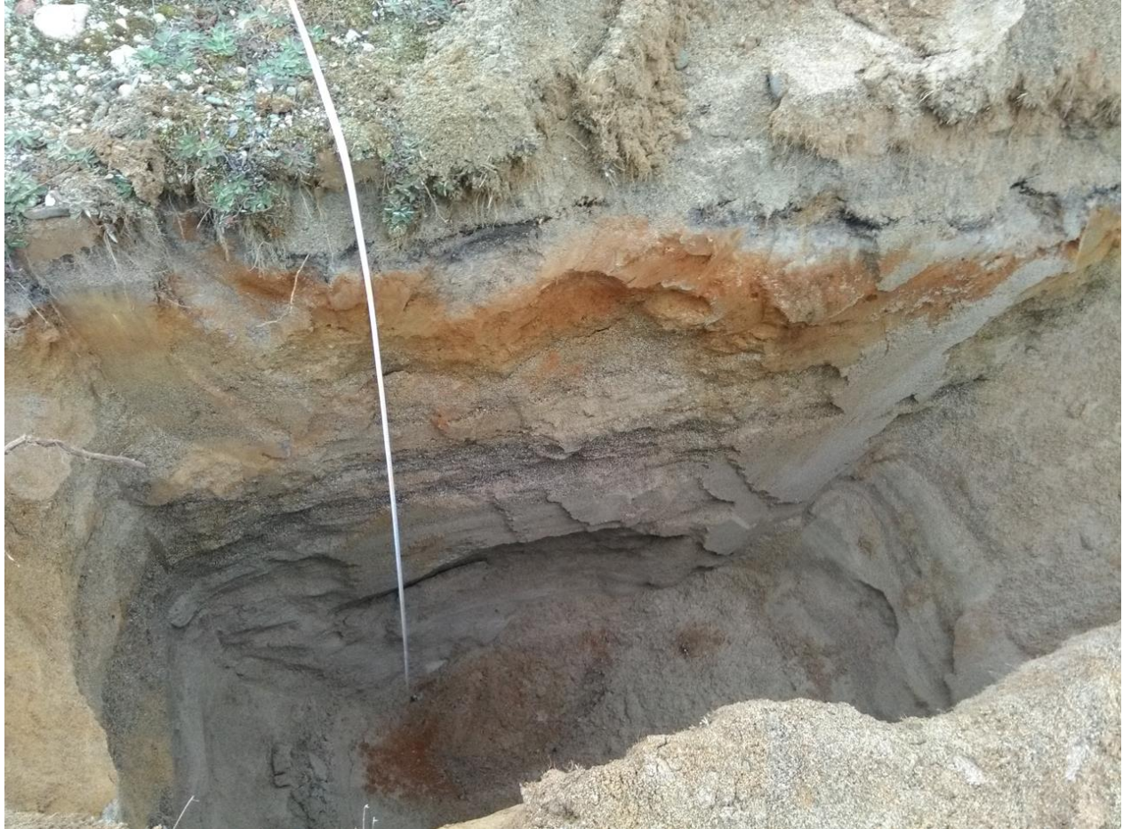
Photo 2: Puits d'exploration PU-01-21 – parois et fond d'excavation
