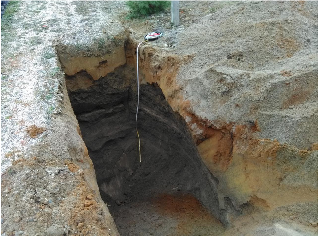
Photo 7: Puits d'exploration PU-02-21 – parois et fond d'excavation
