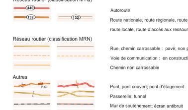
Talus de remblai; talus de déblai Aéroport Voie ferrée; hydrobase, aéroport Piste d'atterrissage Piste d'atterrissage : pavée; non pavée Ligne de transport, pylône, poste de distribution d'électricité Pipeline; tour, tour de télécommunication
